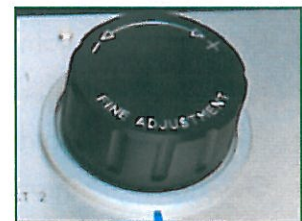
Der präzise variable Volumeneinsteller Minerva MNR 90 ermöglicht eine sehr feine Druckeinstellung bis hinunter auf 100 Pa
