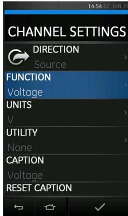
**Abbildung 3-10: Menü „Channel Settings“ (Kanaleinstellungen)**
