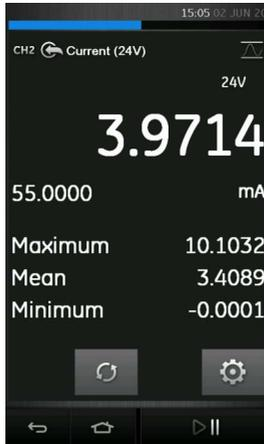
**Abbildung 3-13: Beispiel für „Max/Min/Avg“ (Maximum/Minimum/Mittelwert)**
