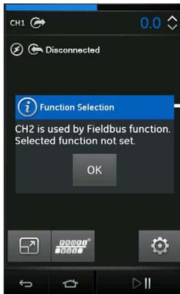
**Abbildung 11-1: CH2-Funktion wird bei aktiviertem Profibus® nicht ausgeführt**
