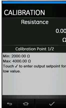
**Abbildung 12-9: Kalibrierung – Widerstand geben CH1 (Bereich: 2000 bis 4000  $\Omega$ )**
