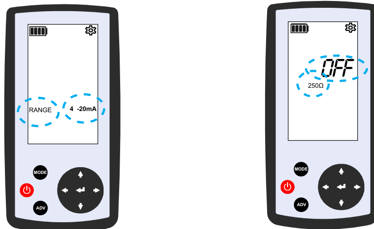
Abbildung 2-6: Einstellungen - Bereich und 250 Ohm Widerstand
