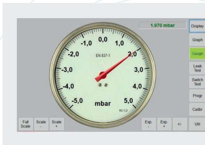
**Leak-Test:** Lecktest-Funktion für Druckverlust- und Dichtigkeitsprüfungen
